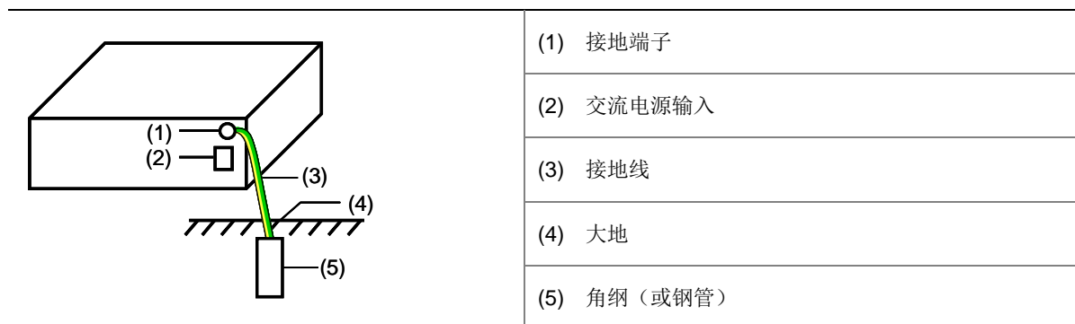
图2-13 接地安装示意图（埋设接地体）
